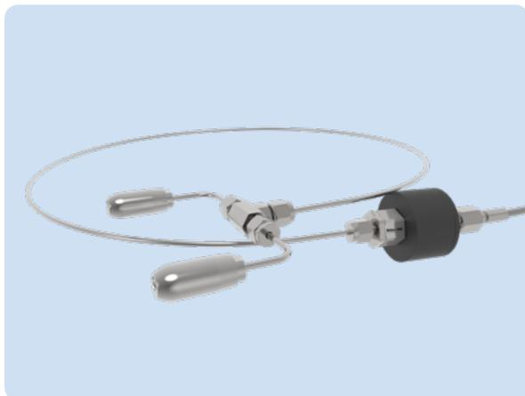
Активная форсунка подключается к отводу от магистрали высокого давления. Она имеет спаренные распыляющие головки. В состав активной форсунки входит регулирующий электромагнитный клапан высокого давления для возможности управления подачей распыляемой воды индивидуально для этого типа форсунки. В форсунках типа SAN используется специальный запатентованный электромагнитный клапан с двумя обмотками, при срабатывании которого не происходит никаких щелчков.
