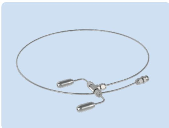
Пассивная форсунка подключается к отводу от магистрали высокого давления. В модели PN1.2SS имеется спаренная распыляющая головка, а также участок трубки из нержавеющей стали, которая позволяет аккуратно вывести распыляющие головки из стены или потолка. В состав пассивной форсунки не входит регулирующий электромагнитный клапан, поэтому форсунка распыляет воду пока в магистрали есть высокое давление. Все форсунки, подключенные к одной магистрали, работают синхронно.
