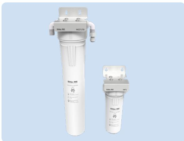
Состоит из двух частей, устанавливаемых до и после модуля умягчения. Первая часть на базе микрокарбонového фильтра предназначена для удаления из воды механических примесей, хлора, различных органических и неорганических загрязнителей с целью защиты центрального модуля и умягчителя SM1. Вторая часть представляет из себя микрофильтр для исключения попадания элементов ионообменной смолы умягчителя в центральный модуль.
