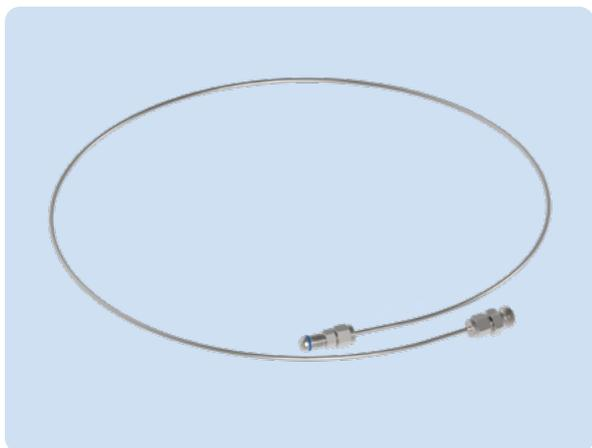
Пассивная форсунка подключается к отводу от магистрали высокого давления. В модели PN3SS имеется участок трубки из нержавеющей стали, которая позволяет аккуратно вывести распыляющую головку из стены или потолка. В состав пассивной форсунки не входит регулирующий электромагнитный клапан, поэтому форсунка распыляет воду пока в магистрали есть высокое давление. Все форсунки, подключенные к одной магистрали, работают синхронно.
